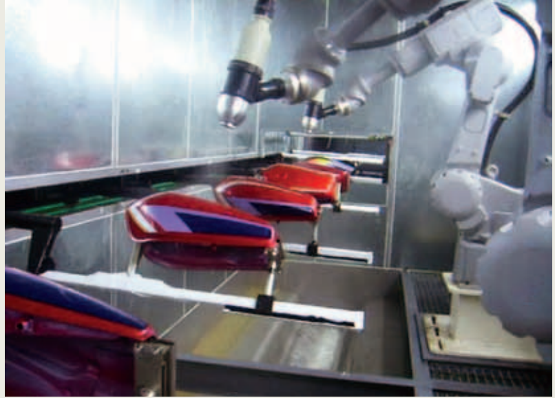
Çinli bir motosiklet üreticisinde motosiklet tankları dönerek boya kabinden geçiyor
